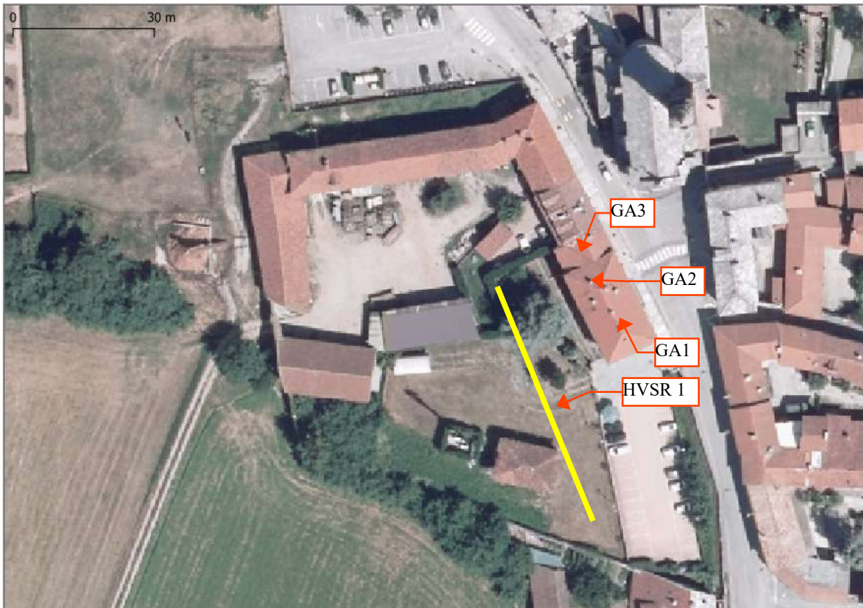
Figura 10 - Ubicazione della stesa MASW (linea gialla) e delle misure HVSr 1 (freccie rosse)
