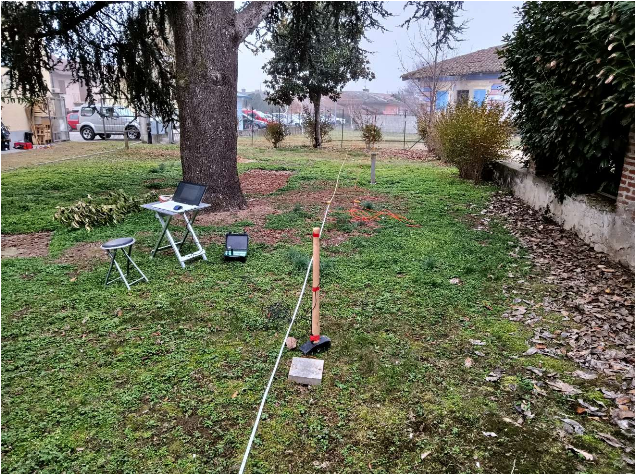
Figura 9 - Array MASW.
